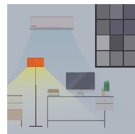
Détection d'ensoleillement. Ajuste la puissance de rafraîchissement en fonction des variations d'intensité de lumière solaire.
